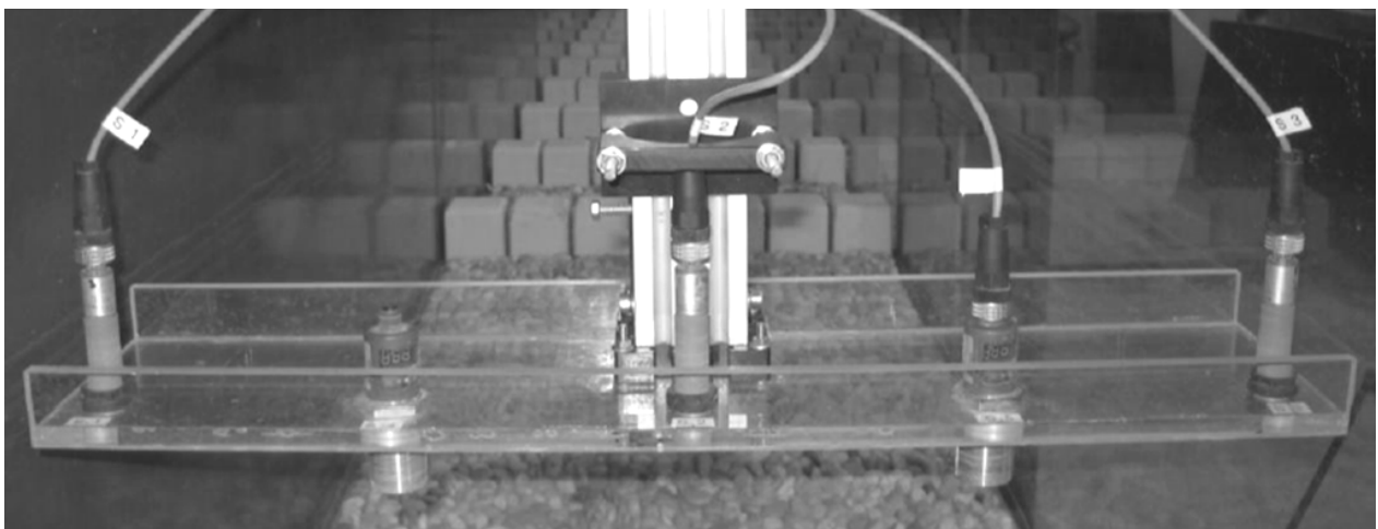
Abbildung 4.16 Messwagen mit Ultraschallsonden unterschiedlicher vertikaler Ausrichtung
