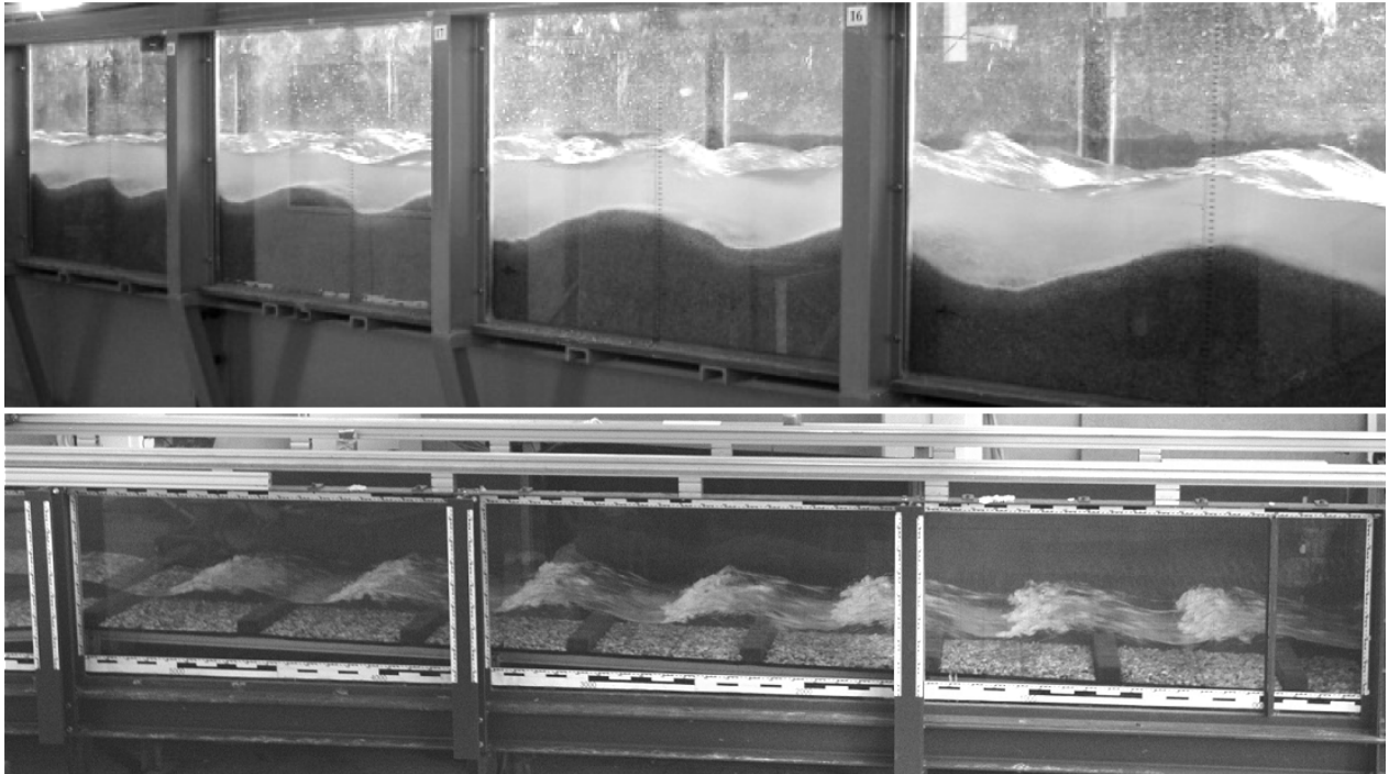
Abbildung 6.37 Fließbild 2D-Antidünen (Núñez-González, Martín-Vide 2010), oben; – Tumbling Flow für Variante I25-K6-L80, raue Sohle, Q = 145 l/s, unten; Fließrichtung jeweils von links nach rechts
