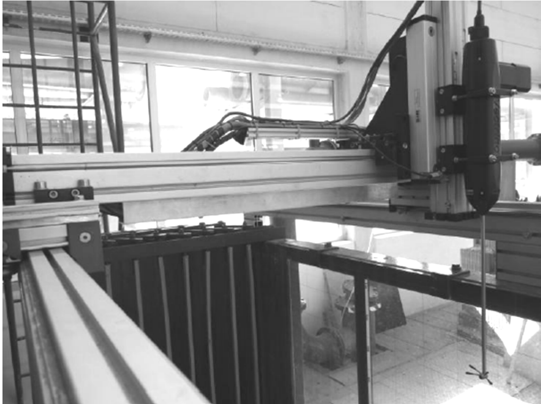
Abbildung 4.12 Side-looking ADV-Sonde Vectrino + auf Positioniersystem am unteren Ende des Glasgerinnes
