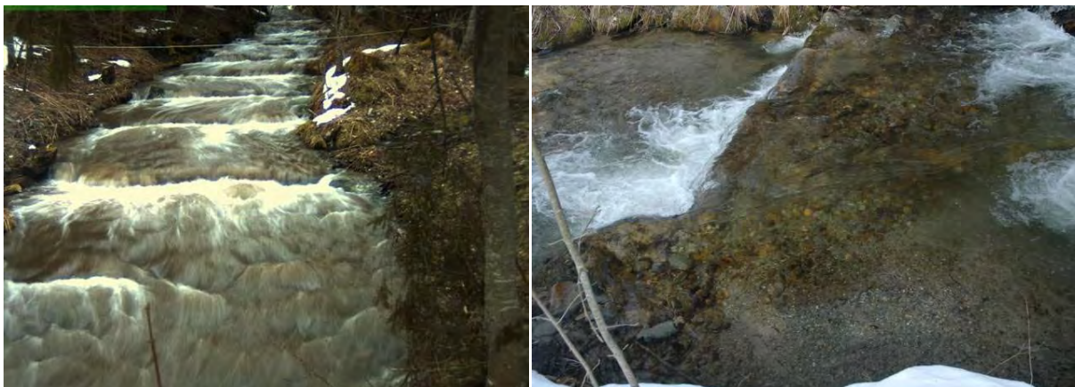
Abbildung 8.1 Schmelzwasserabfluss am 25. März 2010, 18:27, MEZ (links), Sediment-Sortierung in der 4. Riegel-Becken-Einheit der Pendelrampe (rechts)
