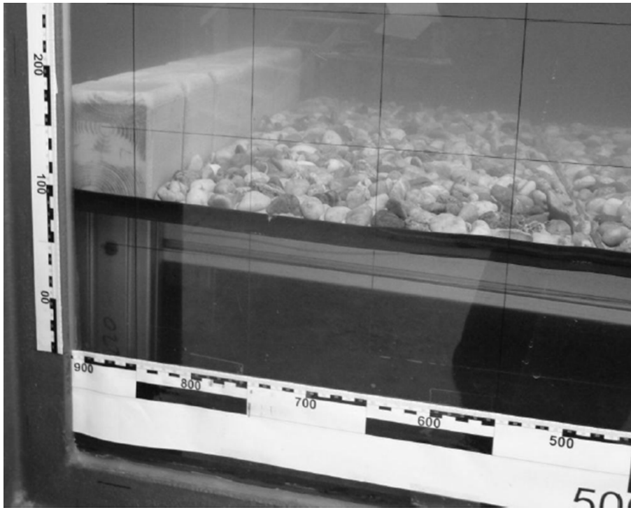
Abbildung 4.4 Rampenkonstruktion (Seitenansicht): Alu-Profil, vertikale Stütze, Rauheitselemente aus Holz, Kunststoffplatten mit Kies, Gummidichtung
